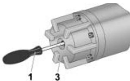
Fig. 4.3. Control del líquido de llenado motor
