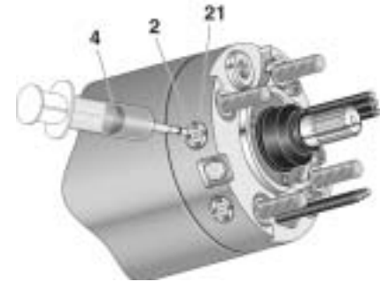
Fig. 4.4. Reponer líquido de llenado del motor
