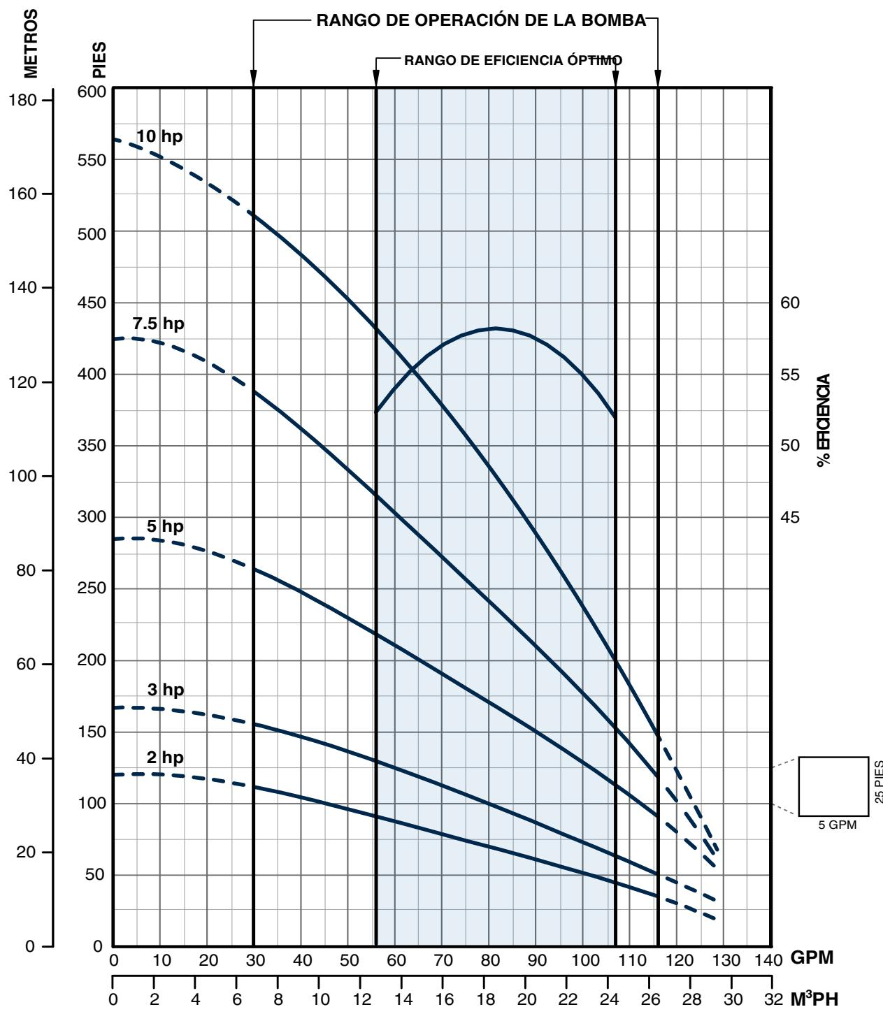
**Notas:** 1. El Rendimiento que se muestra, no incluye la pérdida por fricción en la tubería de descarga.
