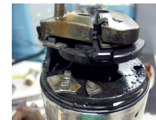
Se requiere un impacto extremo para fracturar/partir los cojinetes
