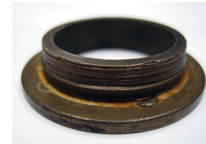
Buje de eslinga de Eje desgastado por arena Visible
