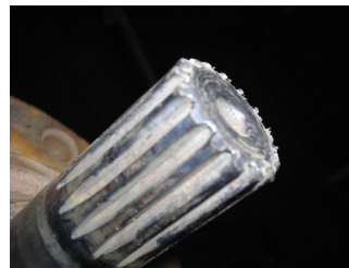
Extremo del eje desgastado por exceso de elementos abrasivos presentes en el entorno del motor
