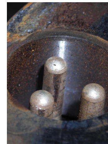
Corrosión y óxido en pines de estator
