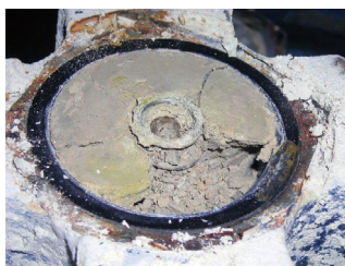
Ejemplo de cavidad de diafragma cuando el motor está enterrado
