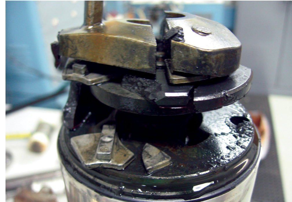
Cojinete de empuje, soporte y segmentos de empuje rotos
