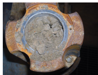
Cavidad del diafragma llena de lodo Motor mostrado arriba
