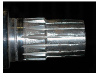
Desgaste en el estriado del eje por presencia excesiva de partículas abrasivas en el entorno
