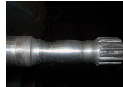
Eje severamente desgastado Visible
