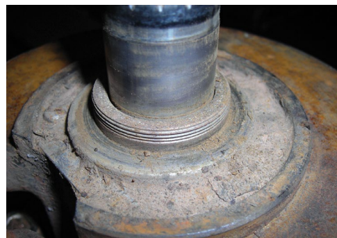
Presencia excesiva de elementos abrasivos
