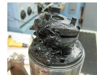
Enfriamiento inadecuado y cargas de empuje sobre las especificaciones
