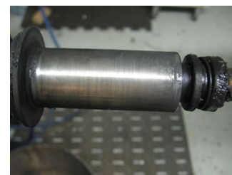
Residuos en el rodamiento Daños en el eje
