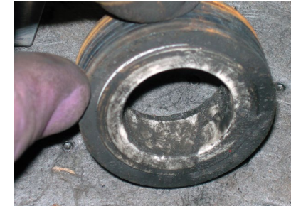
Sello cubierto de abrasivo/ID desgastado No visible
