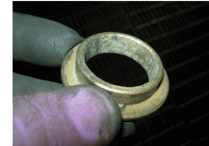
ID del buje del deflector del Eje desgastado No visible
