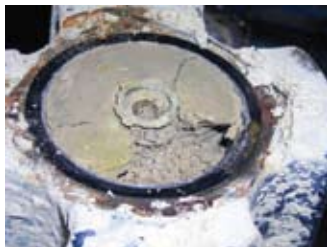
Ejemplo de la cavidad del diafragma en un motor enterrado
