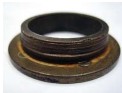
Casquillo del eje desgastado por arena Visible
