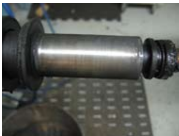
Residuos en cojinete Daño en el Eje
