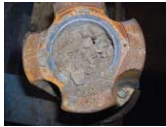
Cavidad del diafragma llena de lodo Del motor mostrado a la izquierda
