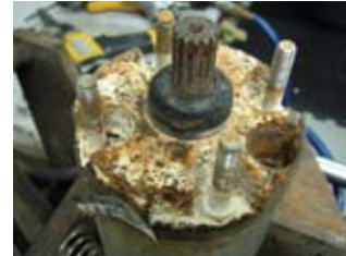
Corrosión - Sin conector No cubierto por garantía
