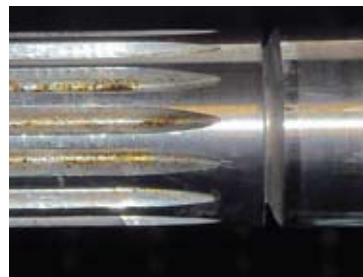
Eje dañado bajo el estriado por insta- lación incorrecta del acoplamiento No cubierto por garantía
