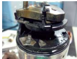
Se requiere un impacto muy fuerte para fracturar/partir los cojinetes
