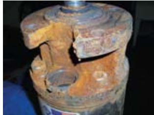
Sedimento - Sin conector instalado No cubierto por garantía
