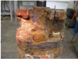
Sedimento - Sin conector instalado No cubierto por garantía
