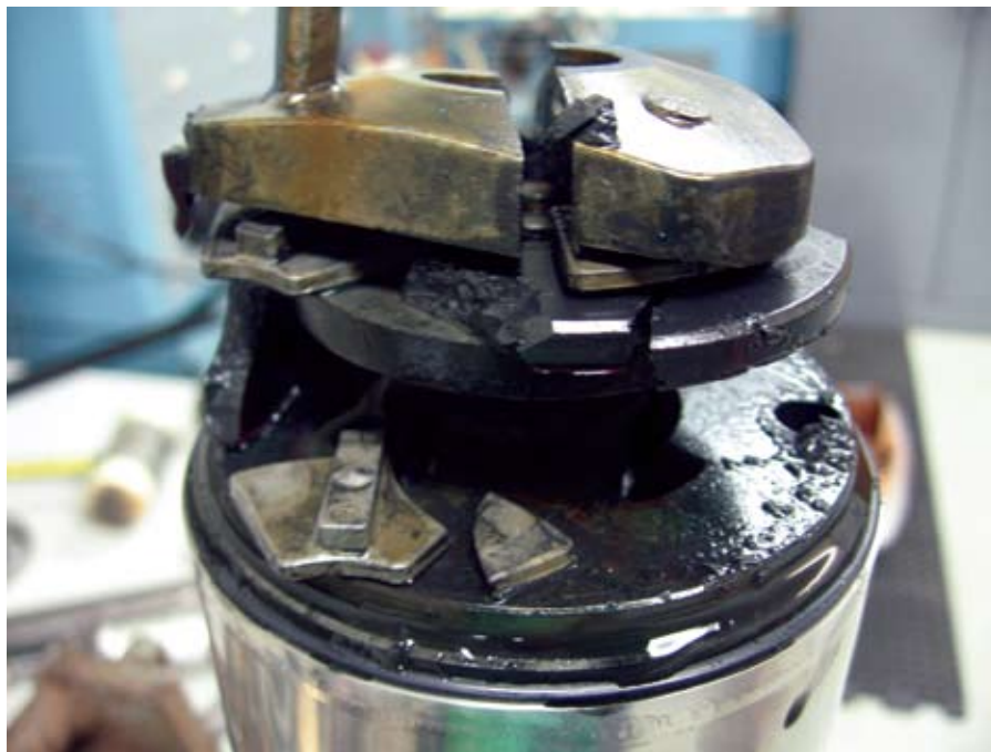
COJINTE DE EMPUJE, SOPORTE Y SEGMENTOS ROTOS
