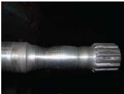
Eje con desgaste severo Visible
