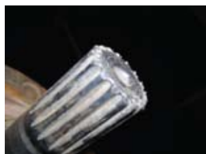
Extremo del eje con desgaste por abrasivos
