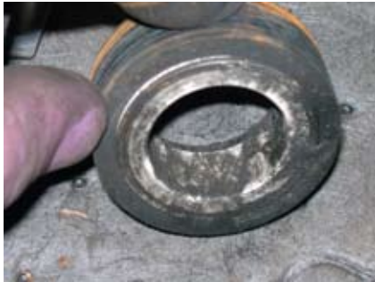
Sello cubierto con abrasivos/DI gastado No Visible
