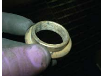
Desgaste en el DI del buje del eje No Visible
