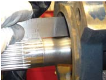
Eje del motor dañado por grava en la succión de la bomba No cubierto por garantía
