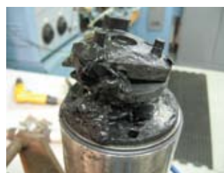
Enfriamiento inadecuado y carga de empuje por encima de la capacidad nominal
