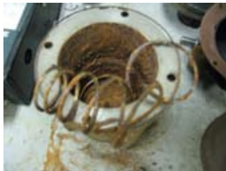
Agua agresiva/con arena o motor en arena.
