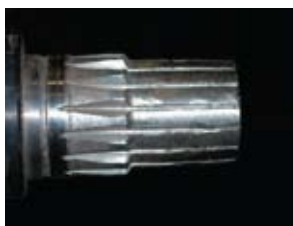
Desgaste en el estriado por abrasivos
