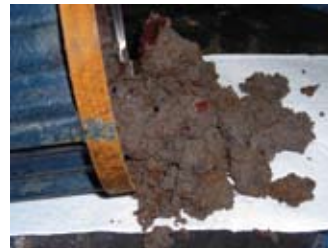
Cubierta de diafragma llena de lodo
