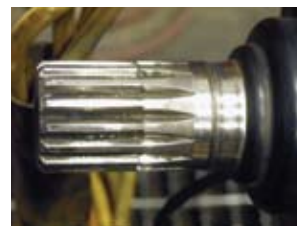
Desgaste por abrasivos en el eje
