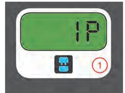
La conexión inalámbrica permanecerá activa un tiempo ilimitado, siempre y cuando no se desconecte el dispositivo móvil. Si se pierde la conexión, el Wi-Fi del variador estará disponible para reconectarse durante una hora. Pasado ese plazo, habrá que reiniciar el variador para restablecer la conexión.
