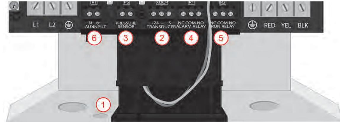
**Nota:** todos los terminales de control aceptan tamaños de cables de 12 a 26 AWG y deben apretarse a un torque de 5 pulg-lbs (0,6 Nm) como máximo.
