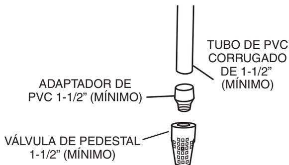
El tamaño del tubo de succión debe aumentar una vez para minimizar la pérdida de presión causada por la fricción de la distancia del tubo.
