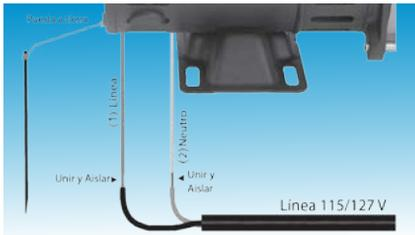
**Figura 1** - Esquema de conexión de los motores eléctricos monofásicos de 127 V.
