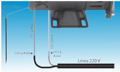
**Figura 2** - Esquema de conexión de los motores eléctricos monofásicos de 220 V.
