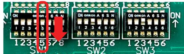
Con transductor de presión, DIP 5 se coloca en "XDRCR" (Hacia abajo)
