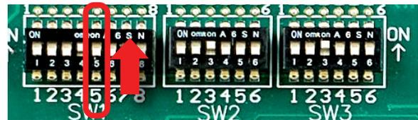
Con sensor de presión, DIP 5 se coloca en "PS" (Hacia arriba)
