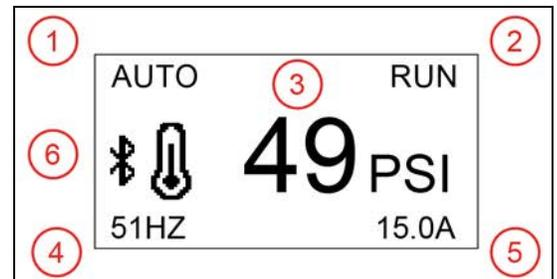
Cuando se usa un sensor de presión estándar, el sistema muestra la velocidad actual del motor (en Hz).
