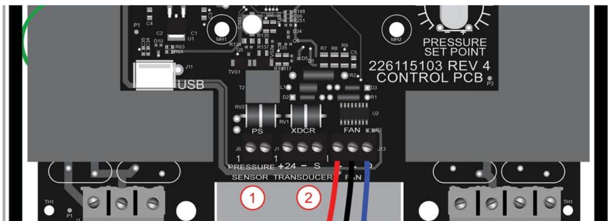
**Tendido de los cables de control** – Pase el cableado del sensor o del transductor de presión por la abertura más pequeña en la parte inferior del variador, a la derecha de los cables de potencia de entrada.
