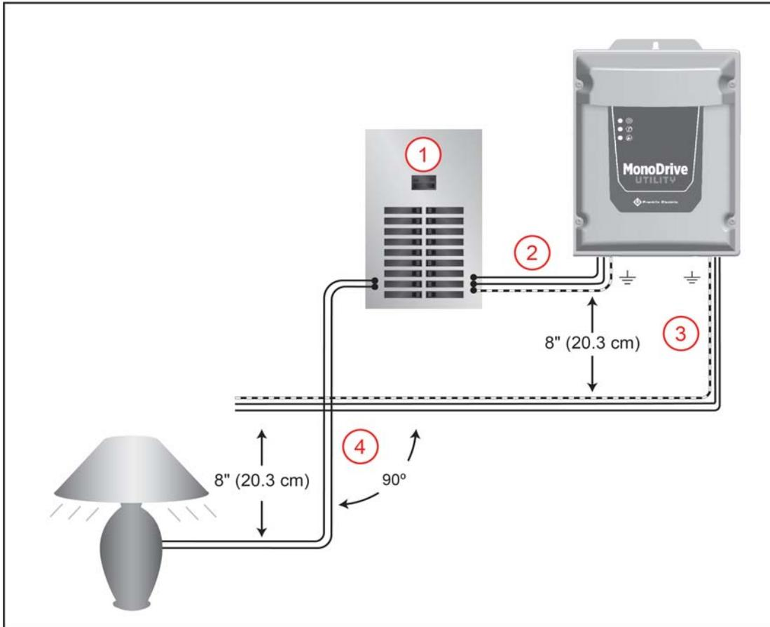
Use el diagrama anterior como guía para el tendido de cables para el VFD.
