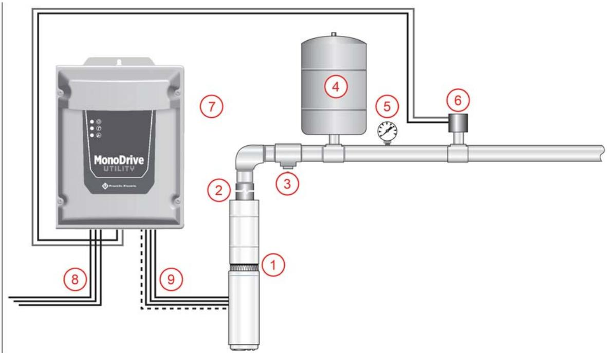
El esquema previo ilustra cómo debería organizarse un sistema de bombeo sumergible típico para una aplicación de presión constante.
