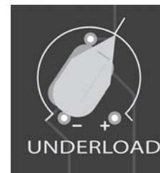
Si fuera necesario ajustar el nivel de desconexión por baja carga, desactive la fuente de alimentación y espere 5 minutos para que el controlador se descargue. Una vez que se hayan disipado los voltajes internos, encuentre el Potenciómetro de baja carga en la esquina superior derecha de la Placa de interfaz del usuario.
