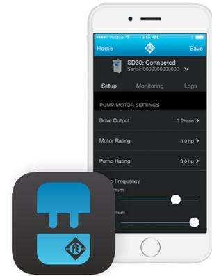
\*Para modificar estas configuraciones usando la aplicación móvil FE Connect, el interruptor DIP FE Connect (SW1 Posición 1) en el variador debe encontrarse en la posición "ON" para encendido. De lo contrario, la unidad trabajará de forma predeterminada con los ajustes realizados a través de los interruptores DIP, el punto de ajuste de presión y el botón giratorio de sensibilidad de baja carga.
