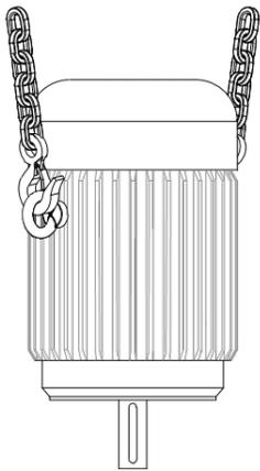
Las armellas en el motor de las bombas se deben utilizar exclusivamente para manipular solo el motor (véase figura. 3). Extraer la bomba del embalaje y revisar que esté en buena condición. Revisar además que los datos en la placa de identificación correspondan a los requeridos. En caso de cualquier defecto contacte inmediatamente al proveedor, reportando la naturaleza del mismo.
